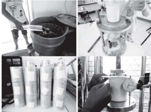
รูปที่ 6 การทดสอบกำลังรับแรงอัดแกนเดียว
