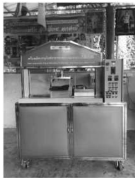
ภาพที่ 2 เครื่องผลิตบรรจุภัณฑ์อาหารจากกากหมากกระบองกึ่งอัตโนมัติ
