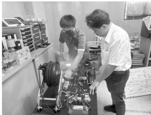
ภาพที่ 2 การต่อชุดฝึกการขับเคลื่อนทางไฟฟ้าโดยใช้มอเตอร์ไฟฟ้ากระแสตรงแบบไร้แปรงถ่าน
