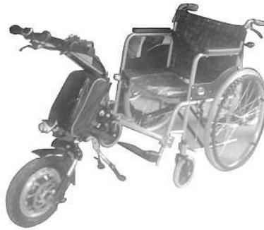
ภาพที่ 3 รถสามล้อไฟฟ้าเพื่อผู้พิการทางขา
