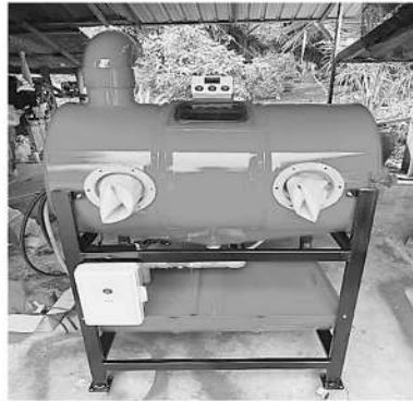
ภาพที่ 4 เครื่องล้างชิ้นส่วนระบบผสมผสาน
