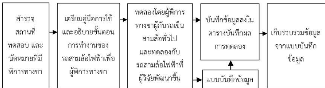
ภาพที่ 4 ขั้นตอนการทดสอบประสิทธิภาพการใช้งานรถสามล้อไฟฟ้าเพื่อผู้พิการทางขา
