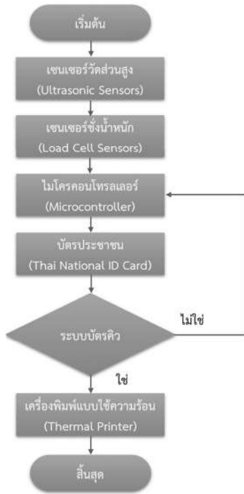
ภาพที่ 2 แผนผังการทำงานของเครื่องพิมพ์แสดงดัชนีมวลกายและคิวง่ายอัตโนมัติของผู้รับบริการด้านสาธารณสุขด้วยข้อมูลบัตรประชาชน
