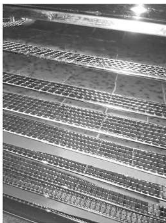
ภาพที่ 3 อบในตู้อบลมร้อน ที่อุณหภูมิ 70 องศาเซลเซียส เป็นเวลา 12 ชั่วโมง
