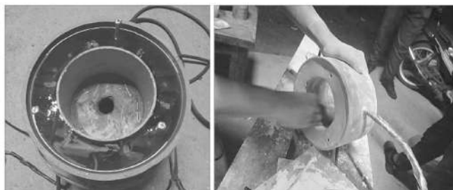
ภาพที่ 4 การหล่อเครื่องกำเนิดไฟฟ้า
