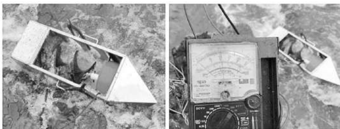
ภาพที่ 6 การทดลองเครื่องผลิตไฟฟ้าอุโมงค์น้ำแรงดันไฟฟ้าที่ผลิตได้ 20 โวลต์
