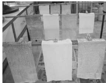
ภาพที่ 2 ผ้าที่เคลือบด้วยน้ำยางพาราทากทิ้งไว้ให้แห้ง
