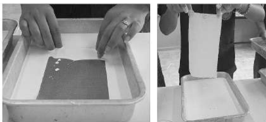
ภาพที่ 1 การจุ่มผ้าในน้ำยางพาราผสมสารเคมี
