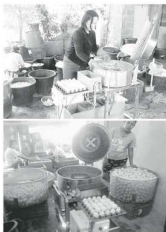
ภาพที่ 10 การหาประสิทธิภาพเครื่องล้างไข่เค็มระบบรีไซเคิลน้ำและการประเมินความพึงพอใจของผู้ใช้
