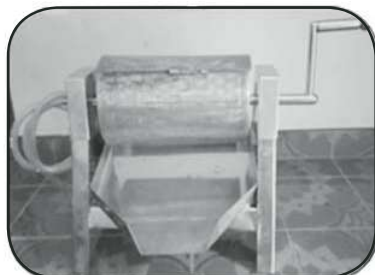
ภาพที่ 4 แสดงสร้างเครื่องล้างเปลือกชาไข่มุกกึ่งอัตโนมัติ
