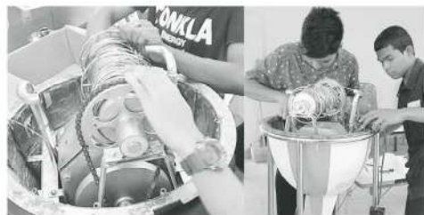
ภาพที่ 6 ประกอบและติดตั้งชุดกำเนิดไฟฟ้า
