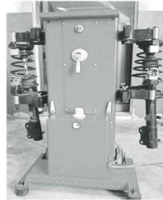
ภาพที่ 8 เครื่องถอดและประกอบใช้คัฟแม็คเฟอร์สันสตรัทแบบถอดประกอบคู่กันอัตโนมัติ
