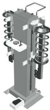
ภาพที่ 5 แบบร่างของเครื่องถอดและประกอบใช้คอปแม็คเฟอร์สันสตรัทแบบถอดประกอบคู่กึ่งอัตโนมัติ
