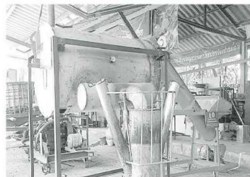
ภาพที่ 8 เครื่องอบผลปาล์มแบบถ้งนอนให้ความร้อนด้วยเตาชีวะมวลแบบเติมเชื้อเพลิงต่อเนื่องพร้อมสุดสกรูลำเลียงผลปาล์ม
