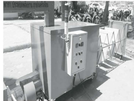
ภาพที่ 5 ตู้อบและรมควันยางพาราแบบประหยัดพลังงาน
