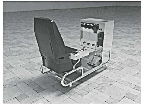
ภาพที่ 3 แบบจำลองเครื่องช่วยผูกไม้กวาดดอกอ้อกิ่งอัตโนมัติ
