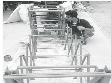
ภาพที่ 1 โครงสร้างภายในตู้อบสำหรับฝังแผ่นยางพารา
