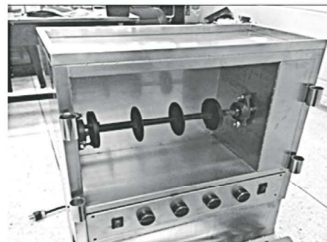
ภาพที่ 4 ชุดควบคุมการเก็บลวดและปล่อยลวด
