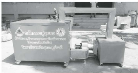
ภาพที่ 4 ตู้อบและรมควันยางพาราแบบประหยัดพลังงาน
