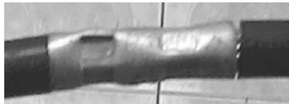
ภาพที่ 4 การย่ำสลีปต่อสายของสายทองแดงกับสายอลูมิเนียม
