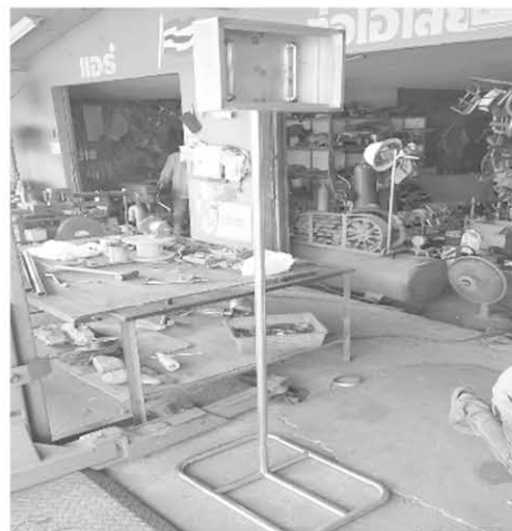
ภาพที่ 2 โครงสร้างเครื่องเตือนภัยระดับน้ำขังบริเวณจุดกลับรถได้สะพานด้วยระบบไมโครคอนโทรลเลอร์
