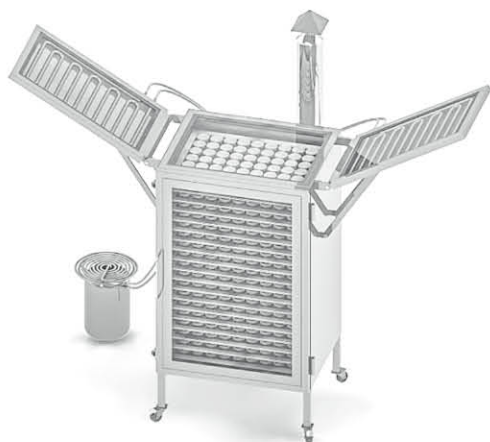
ภาพที่ 4 ออกแบบตู้อบพลังงานแสงอาทิตย์ร่วมกับพลังงานชีวมวล โดยการพาความร้อนแบบบังคับ
