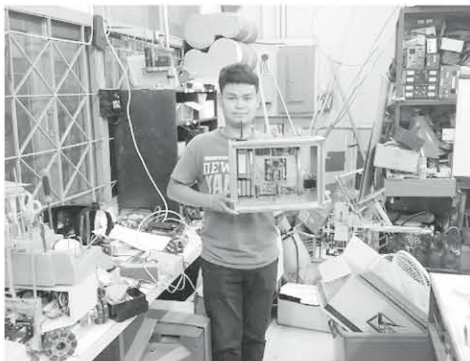
ภาพที่ 4 ชุดควบคุมและชุดแสดงผลของเครื่องเตือนภัยระดับน้ำขังบริเวณจุดกลับรถได้สะพานด้วยระบบไมโครคอนโทรลเลอร์
