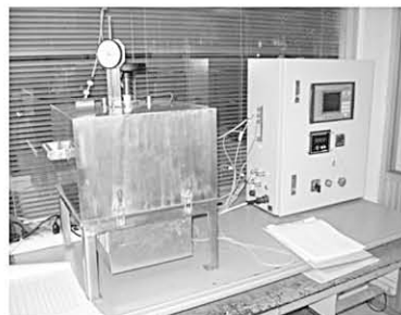
ภาพที่ 2 การทดสอบค่าการนำความร้อนและความต้านทานความร้อนแผ่นกระเบื้องมุงหลังคา
