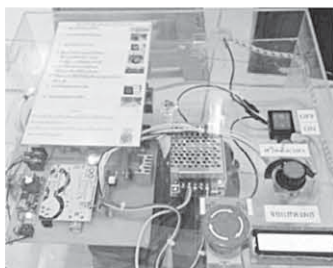
ติดตั้งอุปกรณ์ควบคุมต่างๆ
