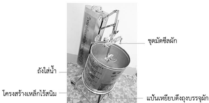
ภาพที่ 2 เครื่องซิลผักสุญญากาศด้วยพลังแรงดันน้ำ
