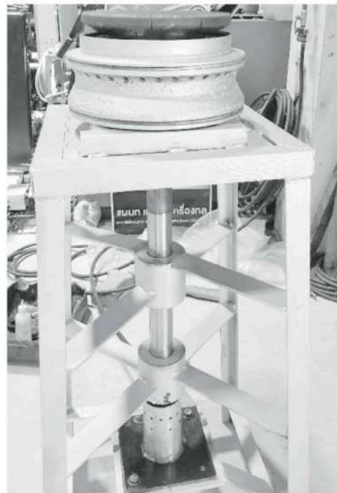
ภาพที่ 6 เครื่องบดวาล์วไอเสียของเครื่องยนต์ดีเซลสำหรับเรือกลเดินทะเลด้วยแรงดันอากาศ
