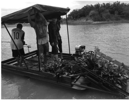
ภาพที่ 5 การทดลองเก็บผักตบชวาและขยะลอยน้ำของเรือเก็บผักตบชวาขนาดเล็ก
