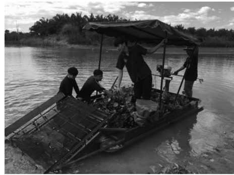
ภาพที่ 5 การทดลองเก็บผักตบชวาและขยะลอยน้ำของเรือเก็บผักตบชวาขนาดเล็ก
