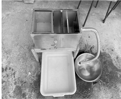
ภาพที่ 1 ถังดักไขมันจากการผลิตอาหารภายในเรือสินค้าที่สมบูรณ์
