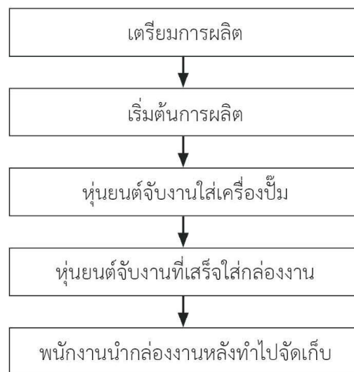
ภาพที่ 1 ขั้นตอนของกระบวนการปั๊มขึ้นรูป
