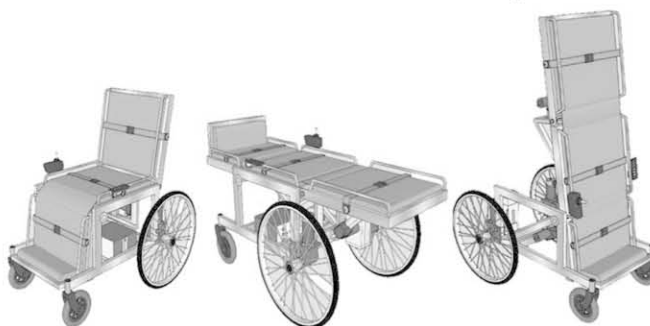
ก) รถเข็นไฟฟ้าปรับนั่ง ข) รถเข็นไฟฟ้าปรับนอน ค) รถเข็นไฟฟ้าปรับยืน
