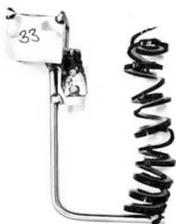
ภาพที่ 1 เครื่องปอกสายแบบใช้แรงหมุนปอกสายแบบ 360 องศา
