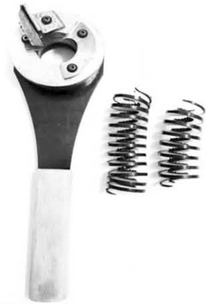
ภาพที่ 7 เครื่องปอกสายเคเบิลขนาด 185 ตร.มม. แบบโยก 10 - 45 องศาที่สมบูรณ์
