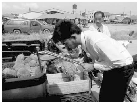
ภาพที่ 4 แสดงการทดลองใช้อุปกรณ์สำหรับปอกเปลือกทุเรียนแบบ Knock Down
