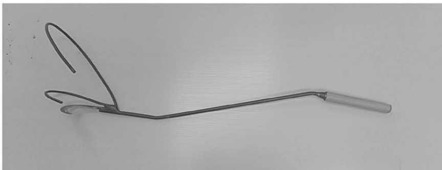
ภาพที่ 2 โครงสร้างหลักของ อุปกรณ์ตัดข้าวผลสับปะรดที่สมบูรณ์
