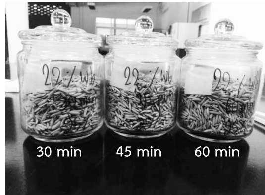
ภาพที่ 4 สีของกระดาศเคลือบสารโคบอลต์คลอไรด์ที่บรรจุในโหลแก้วกับข้าวเปลือกความชื้น 22 %w.b. เป็นเวลา 30, 45 และ 60 นาที
