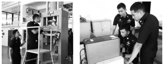
ภาพที่ 3 การทดสอบกำลังรับแรงอัดของคอนกรีต
