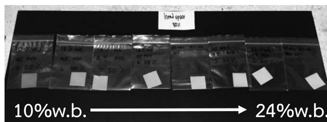
ภาพที่ 5 การเปลี่ยนแปลงสีของกระดาศเคลือบสารโคบอลต์ คลอไรด์ที่บรรจุในโหลแก้วกับข้าวเปลือกเป็นเวลา 45 นาที
