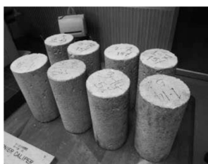
ภาพที่ 4 ตัวอย่างทดสอบและการทดสอบกำลังรับแรงดึงของคอนกรีต
