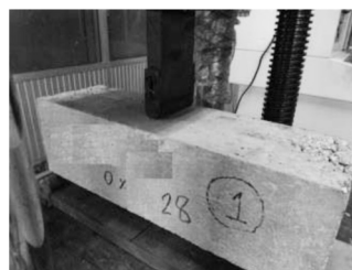
ภาพที่ 5 การทดสอบกำลังรับแรงดัดของคอนกรีต
