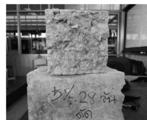
ภาพที่ 5 การทดสอบกำลังรับแรงดัดของคอนกรีต
