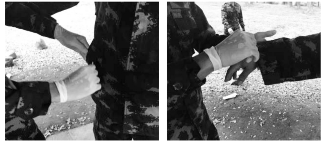
ภาพที่ 8 การตรวจหา TNT จากเสื้อผ้าของผู้ที่ประกอบวัตถุระเบิด
