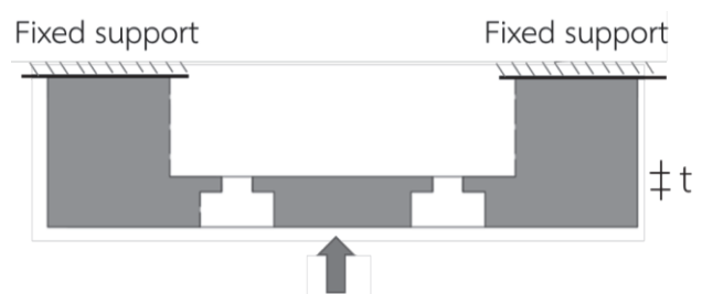
ภาพที่ 16 เจือ้นไขสภาวะแวดล้อมที่ใช้ในการวิเคราะห์ด้วยระเบียบวิธีไฟไนต์เอลิเมนต์ของโหลดเซลล์แบบที่ 2
