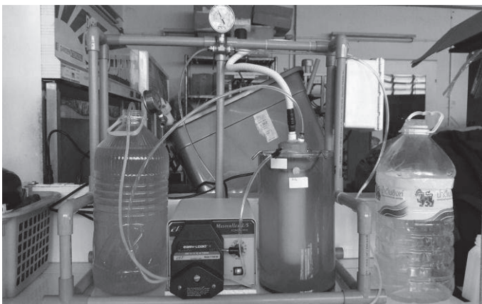
ภาพที่ 2 ระบบถังปฏิกรณ์เมมเบรนและโฟโตคะตะไลติกเมมเบรน
