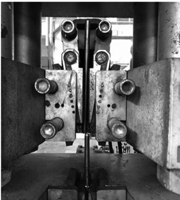
ภาพที่ 17 การทดสอบการดึงวัสดุชิ้นงานที่ 1
