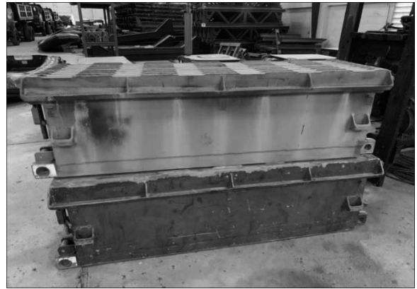
ภาพที่ 3 ชิ้นส่วนโครงบนสะพานทหาร เอ็ม จี บี
