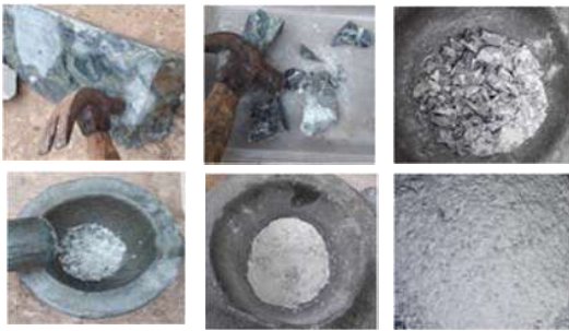
ภาพที่ 5 กระบวนการบดหยกเนไฟรต์ก่อนทำการขึ้นรูป
