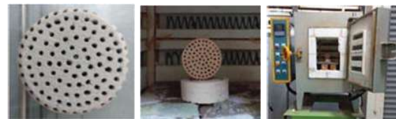
ภาพที่ 7 การขึ้นรูปหยกเนไฟรต์กับดินคอมพาวด์และการนำเข้าเตาเผาอุณหภูมิสูง
