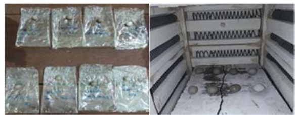
ภาพที่ 2 หยกปั้นขึ้นรูปทรงกลมเตรียมเผาในเตาความร้อนสูง
