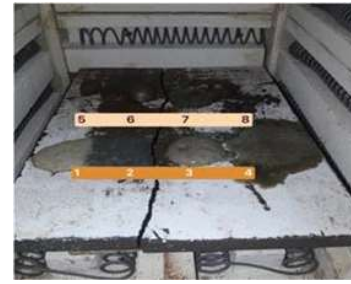
ภาพที่ 4 หยกที่ผสมดินคอมพาวด์เพื่อทดสอบการทนความร้อน
