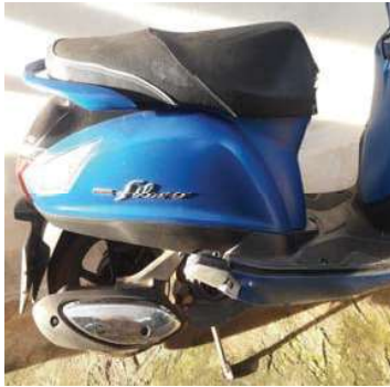
ภาพที่ 9 รถจักรยานยนต์ Grand Filano ที่ติดตั้งท่อไอเสียที่มีแคตตาไลติก คอนเวอร์เตอร์ หยกเนฟไตร์ ภายในคอท่อไอเสีย
