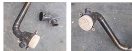
ภาพที่ 8 การติดตั้งชุดแคตตาไลติก คอนเวอร์เตอร์หยกเนไฟรต์ กับชุดคอท่อไอเสียที่ได้ออกแบบ
