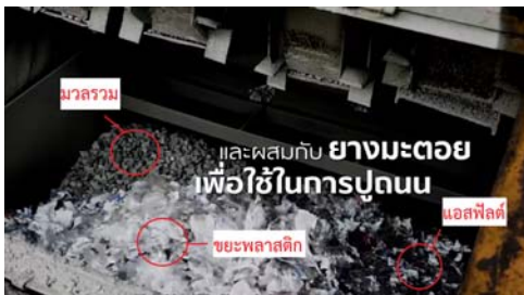
ภาพที่ 1 การผสมแอสฟัลต์คอนกรีตกับถุงพลาสติกรีไซเคิล
