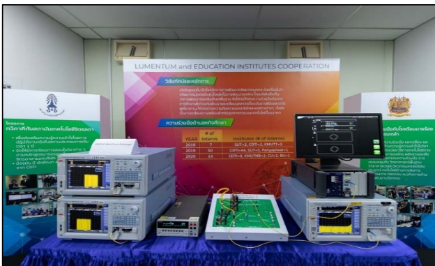
ภาพที่ 1 ชุดสาธิตการส่งสัญญาณแสงใช้งานร่วมกับเครื่อง Optical Spectrum Analyzer
