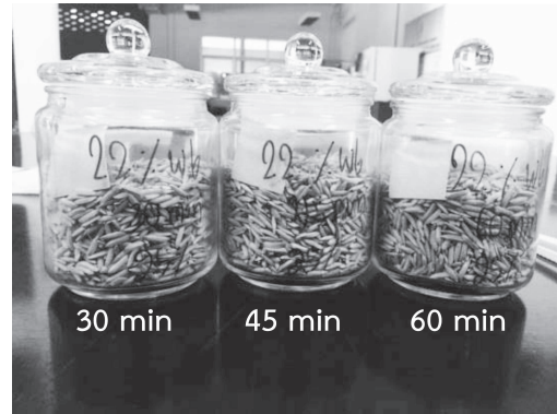
ภาพที่ 4 สีของกระดาษเคลือบสารโคบอลต์คลอไรด์ที่บรรจุในโหลแก้วกับข้าวเปลือกความชื้น 22 %w.b. เป็นเวลา 30, 45 และ 60 นาที
