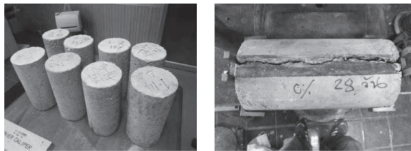
ภาพที่ 4 ตัวอย่างทดสอบและการทดสอบกำลังรับแรงดึงของคอนกรีต
