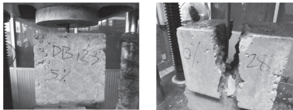
ภาพที่ 6 การทดสอบแรงยึดเหนี่ยวของคอนกรีตผสมน้ำยางต่อเหล็กเสริม
