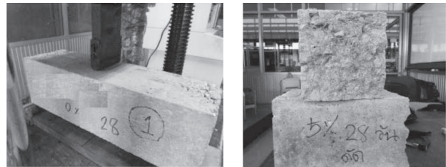
ภาพที่ 5 การทดสอบกำลังรับแรงดัดของคอนกรีต
