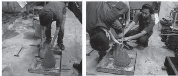
ภาพที่ 2 การทดสอบความสามารถในการเทได้ของคอนกรีตโดยวิธีการทดสอบหาค่าการยุบตัวของคอนกรีต
