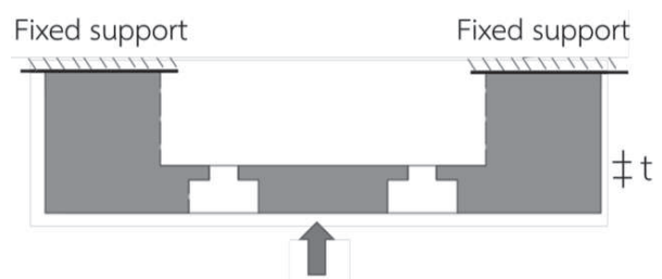
ภาพที่ 16 เจ็อนไซสภาวะแวดล้อมที่ใช้ในการวิเคราะห์ด้วยระเบียบวิธีไฟไนต์เอลิเมนต์ของโหลดเซลล์แบบที่ 2
