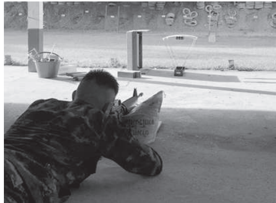
ภาพที่ 5 นอนราบยิงทดสอบผ่านเครื่องวัดความเร็ว
