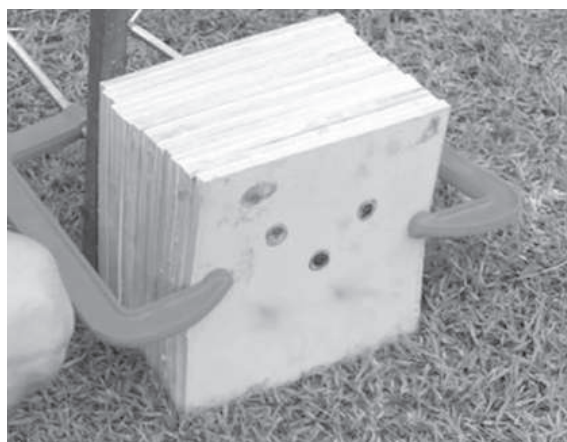
ภาพที่ 2 แผ่นทดสอบยางคอมพาวด์ประกบยึดติดกันโดยแक्रमรูปตัวยู
