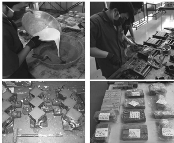
ภาพที่ 2 การผสมวัสดุเคลือบผิวคลองและบรรจุในแบบหล่อ
