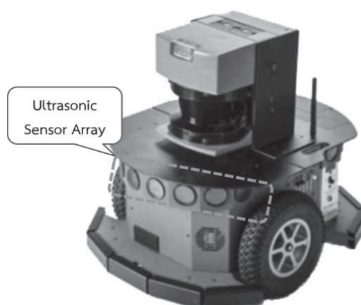
ภาพที่ 2 การใช้เซนเซอร์อัลตราโซนิกในยานควบคุมอัตโนมัติ
