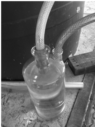
ภาพที่ 8 การกำจัดแก๊สคาร์บอนไดออกไซด์จากแก๊สชีวภาพวิธีที่ 3
