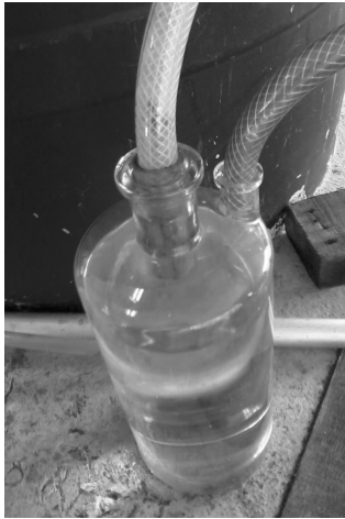
ภาพที่ 7 การกำจัดแก๊สคาร์บอนไดออกไซด์จากแก๊สชีวภาพวิธีที่ 2
