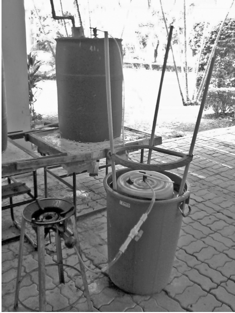
ภาพที่ 3 ถังหมักแก๊สชีวภาพขนาดเล็กต่อประกอบกับชุดถังรับแก๊สและเตาหุงต้มแบบครีวเรือน
