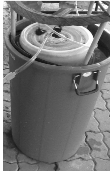
ภาพที่ 9 การกำจัดแก๊สคาร์บอนไดออกไซด์จากแก๊สชีวภาพวิธีที่ 4
