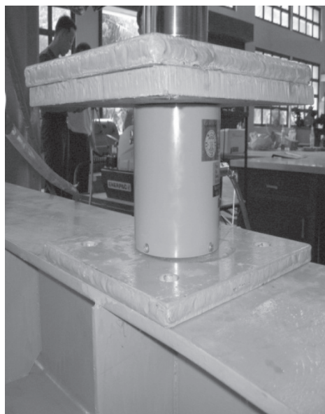
ภาพที่ 14 เครื่องมือวัดขนาดของแรงที่กระทำขนาด 100 ตัน (100 Tons Load Cell)
