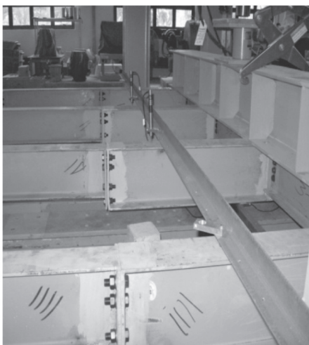
ภาพที่ 18 การโก่งตัวของโครงเหล็กเสริม
