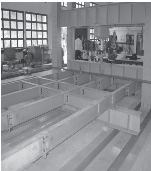
ภาพที่ 9 โครงเหล็กเสริมต้นแบบเมื่อประกอบเรียบร้อยพร้อมทดสอบ
