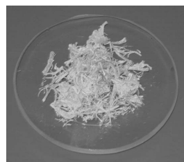
(ก) ผลิตภัณฑ์ที่ได้หลังจากทำปฏิกิริยาระหว่างเส้นใยจากขานอ้อยกับกรดผสม
