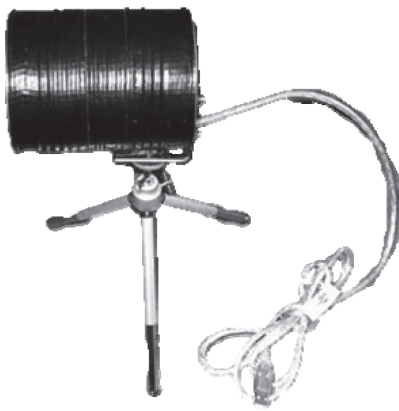
รูปที่ 6 สายอากาศแบบกระป๋อง (Cantenna) ซึ่งสร้างโดยนักเรียนนายร้อย ชั้นปีที่ 4 ร่วมโครงการสามารถส่งได้ระยะไกลประมาณ 300 เมตร
