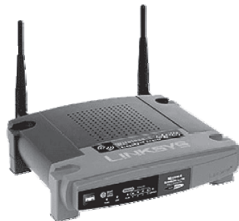
รูปที่ 1 อุปกรณ์เชื่อมต่อเครือข่ายไร้สาย (access point) ของ LinkSys รุ่น WRT54GL ซึ่งใช้เป็นโหนดของระบบ Mesh
