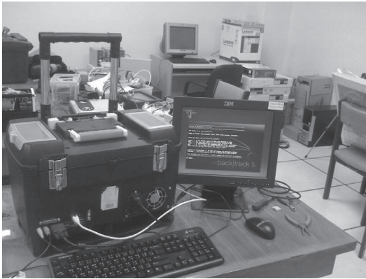
รูปที่ 12 ต้นแบบ 3S-MN รุ่นที่สอง ประกอบด้วยเข้ากับกล่องที่สามารถเคลื่อนย้ายได้ง่าย และใช้พลังงานจากแบตเตอรี่
