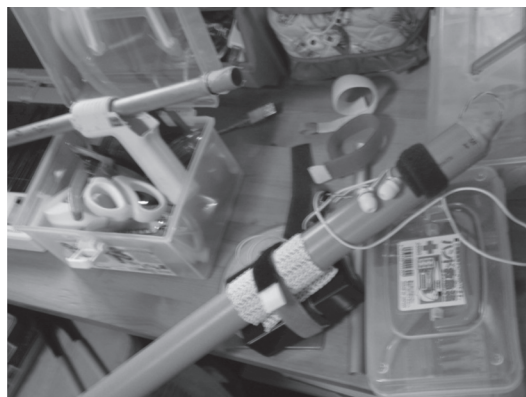
รูปที่ 10 ต้นแบบเครื่องดักฟังเสียง SS-P02 แบบใช้ท่อนำเสียงทำจากท่อพีวีซีขนาด 0.5 นิ้ว และ 1.5 นิ้ว และไมโครโฟนแบบ A
