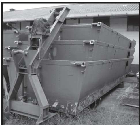
รูปที่ 9 การขนส่งเรือของสะพาน MGB
