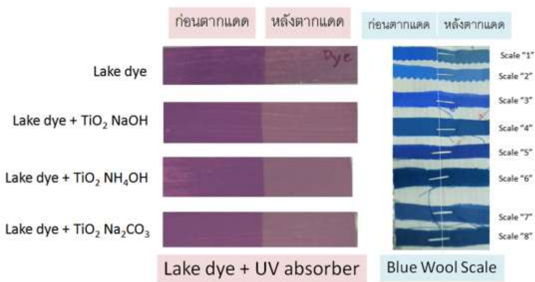
รูปที่ 7 ภาพถ่ายชิ้นงาน Lake dye ที่เติมผงไทเทเนียมไดออกไซด์อัสฐานที่สังเคราะห์ได้ก่อนและหลังตากแดดเป็นเวลา 48 ชั่วโมง
