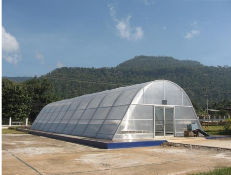
รูปที่ 3 เครื่องอบแห้งแบบพาราโบลาโดมที่จัดสร้างในปี พ.ศ. 2550
