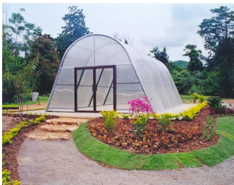
รูปที่ 2 เครื่องอบแห้งแบบพาราโบลาลาโดมที่โครงการอุทยานธรรมชาติในพระตำหนักของสมเด็จพระเทพรัตนราชสุดาฯ สยามบรมราชกุมารี อำเภอสวนผึ้ง จังหวัดราชบุรี เมื่อ พ.ศ. 2547
