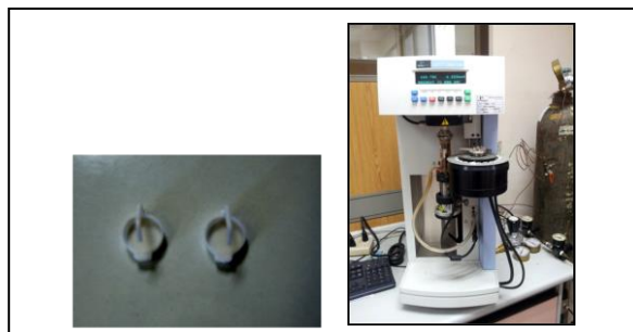
รูปที่ 2 ที่ใส่ตัวอย่าง Ceramic Crucible ของเครื่อง TGA ที่ใช้ในการทำการทดลอง
