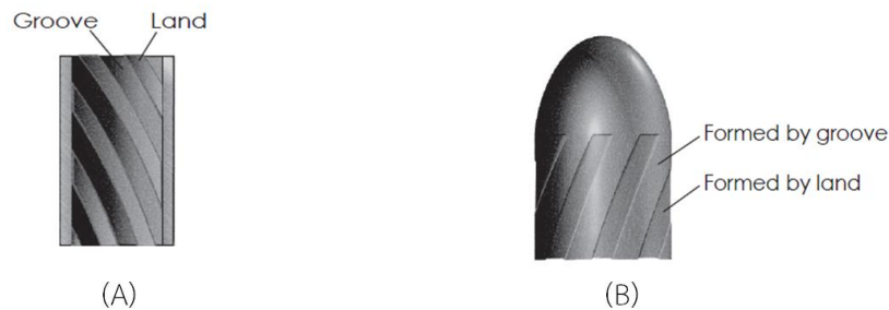
ภาพที่ 2 (A) ร่องเกลียวสันเกลียวภายในลำกล้องปืน, (B) รูปแบบของรอยตำหนิที่เกิดขึ้นบนพื้นผิวลูกกระสุนปืน (American bar association section of science & technology law, 2007)
