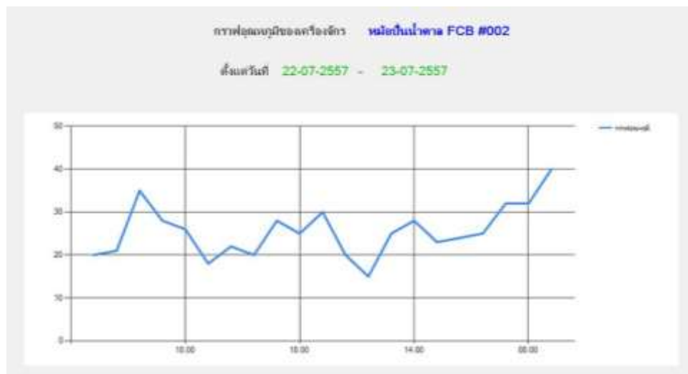
ภาพที่ 10 ตัวอย่างกราฟแสดงอุณหภูมิที่ผิดปกติของหม้อป่นน้ำตาล
