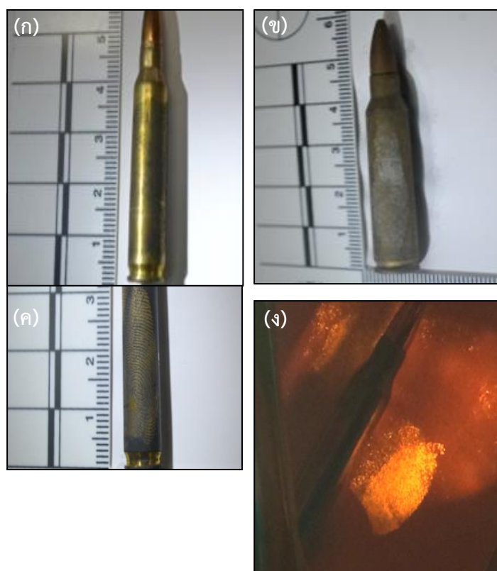
รูปที่ 1 การปรากฏของรอยลายนิ้วมือบนปลอกกระสุนปืนเล็กกล ขนาด 5.56 มม. ก่อนทำการยิงปืน เมื่อตรวจโดยใช้ (ก) วิธีการปิดผงฝุ่น, (ข) วิธีการ super glue, (ค) วิธีการ perma blue ณ เวลาที่ 48 ชั่วโมง และ (ง) วิธีการทางเคมีและฟิสิกส์ (1,2-indanedione ร่วมกับ polylight)
