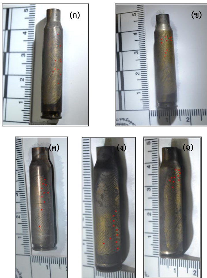
รูปที่ 3 จุดตำหนิพิเศษด้วย AFIS ของรอยลายนิ้วมือแฝงบนปลอกกระสุนปืนเล็กกล ขนาด 5.56 มม. ที่ตรวจโดยใช้วิธีการ perma blue หลังการทำการยิง ณ เวลา (ก) 3 ชั่วโมง (ข) 6 ชั่วโมง (ค) 12 ชั่วโมง (ง) 24 ชั่วโมง และ (จ) 48 ชั่วโมง ตามลำดับ
