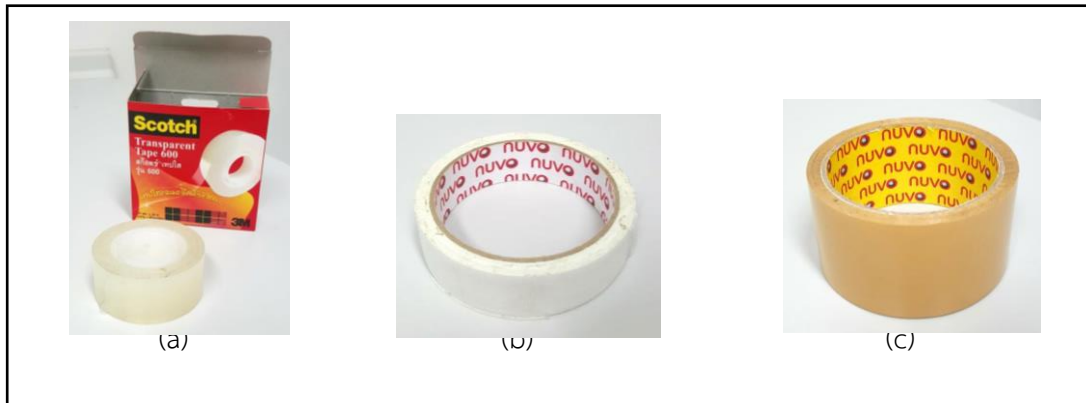
ภาพที่ 1 เทปกาวที่ใช้เป็นพื้นผิวสำหรับตรวจหารอยลายนิ้วมือ ได้แก่ (a) เทปใสยี่ห้อ Scotch รุ่น Transparent tape 600 (b) เทปผ้าขาวยี่ห้อ NUVO (c) เทปพลาสติกสีน้ำตาลยี่ห้อ NUVO
