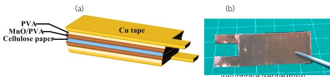
(b) เซลล์แมงกานีสออกไซด์/พอลิไวนิลอัลกอฮอล์นาโนคอมพอสิตจริง
