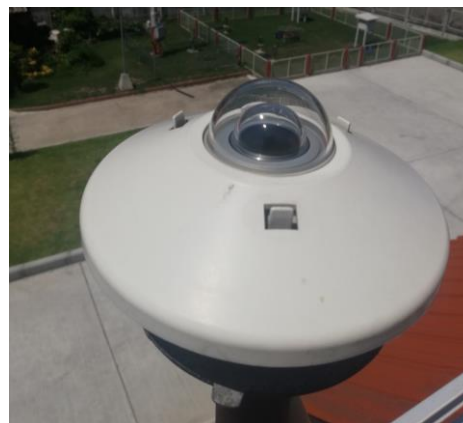
ภาพที่ 2 ไพรานอมิเตอร์ ณ สถานีวัดปริมาณรังสี อาทิตย์ จ.ชลบุรี ของกรมพัฒนาพลังงานทดแทนและ อนุรักษ์พลังงาน
