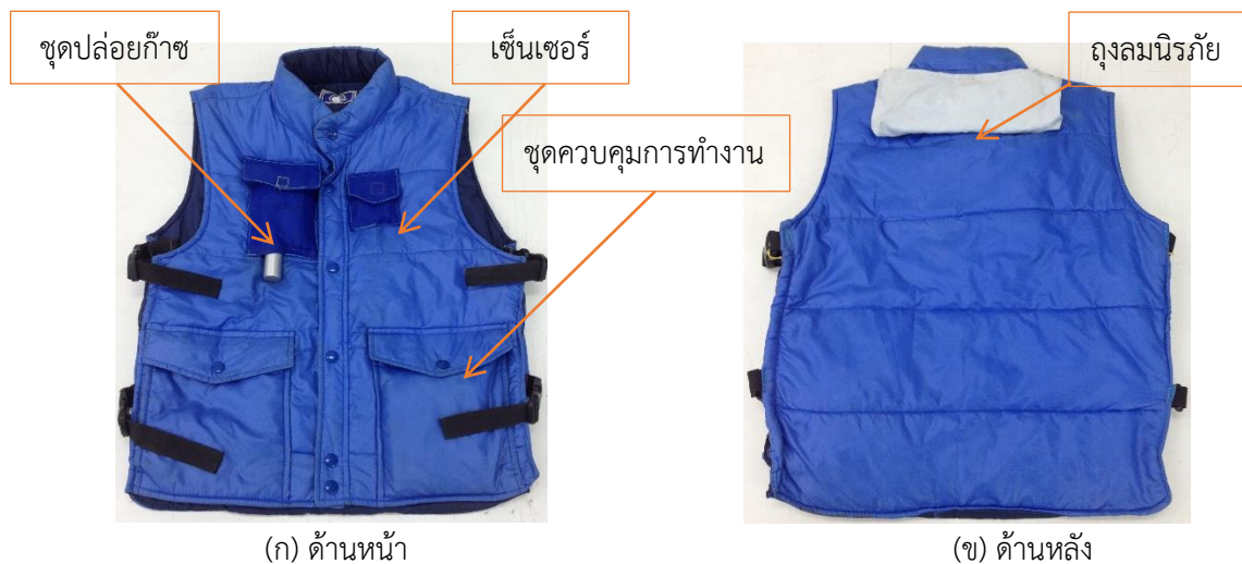
ภาพที่ 6 การติดตั้งอุปกรณ์บนเสื้อถุงลมนิรภัย
