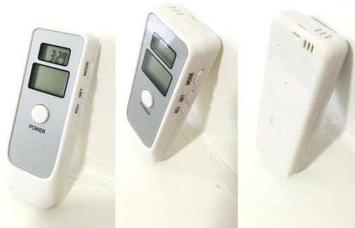
รูปที่ 1 เครื่องวัดระดับแอลกอฮอล์ในเลือดที่ใช้ในการวิจัย และเครื่อง Gas Chromatography รุ่น GC – 17A ยี่ห้อ SHIMADZU
