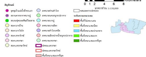
ภาพที่ 10 ระดับความเหมาะสมของพื้นที่ต่อการพัฒนาเป็นบ่อฝังกลบขยะอย่างถูกหลักสุขาภิบาลจากการวิเคราะห์ด้วยระบบสารสนเทศภูมิศาสตร์
